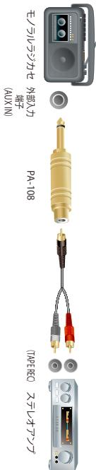
使用例：RCAピンプラグを3.5φミニプラグに変換する場合 PA-108
